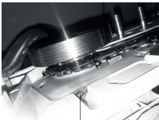
Винт регулировки подачи масла (Oil feed adjustment screw)
